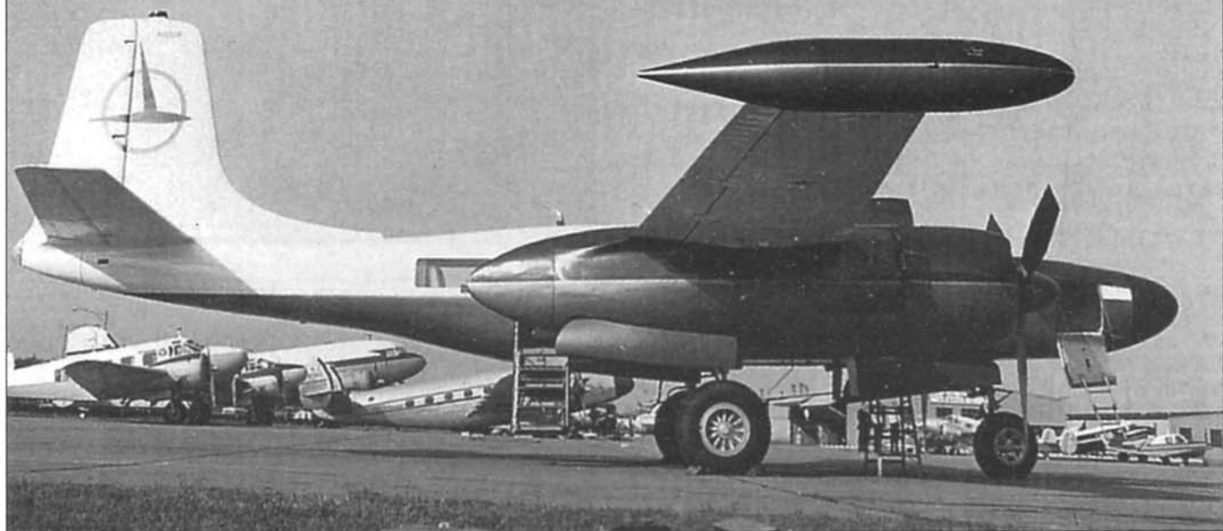
Пассажирский самолет он Марк «Мэркитир», открыт люк багажного отсека в носовой части фюзеляжа. Также открыта дверца пассажирского салона.
