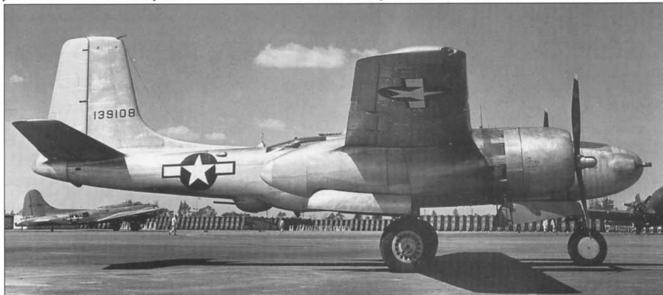
А-26В ранней постройки, в носовой части фюзеляжа установлена 75-мм пушка.
