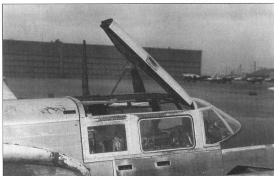
Мощная крыша фонаря кабины открывается вперед. В аварийной ситуации покинуть кабину через верх практически невозможно.
