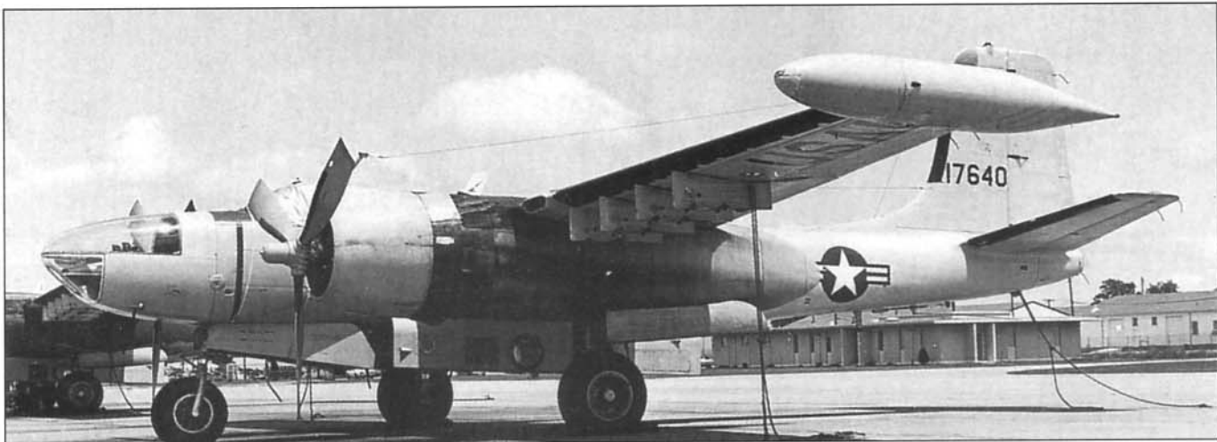
Разведчик RB-26K, хорошо видны окна под объективы АФА в створке бомбоотсека. В носовой части фюзеляжа также установлена фотоаппаратура.
