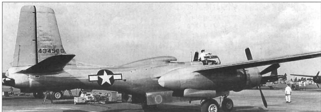
Летающая лаборатория для испытаний ТРД J31 – самолет ХА-26F.
