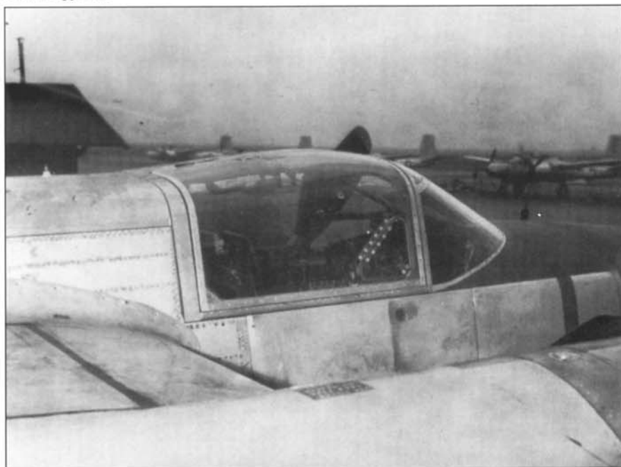
Для решения проблемы аварийного покидания кабины фирма Дуглас исследовала различные варианты остекления фонаря кабины. В конечном итоге был выбран почти беспереплетный фонарь с ярко выраженной каплеобразностью подвижных сегментов.
