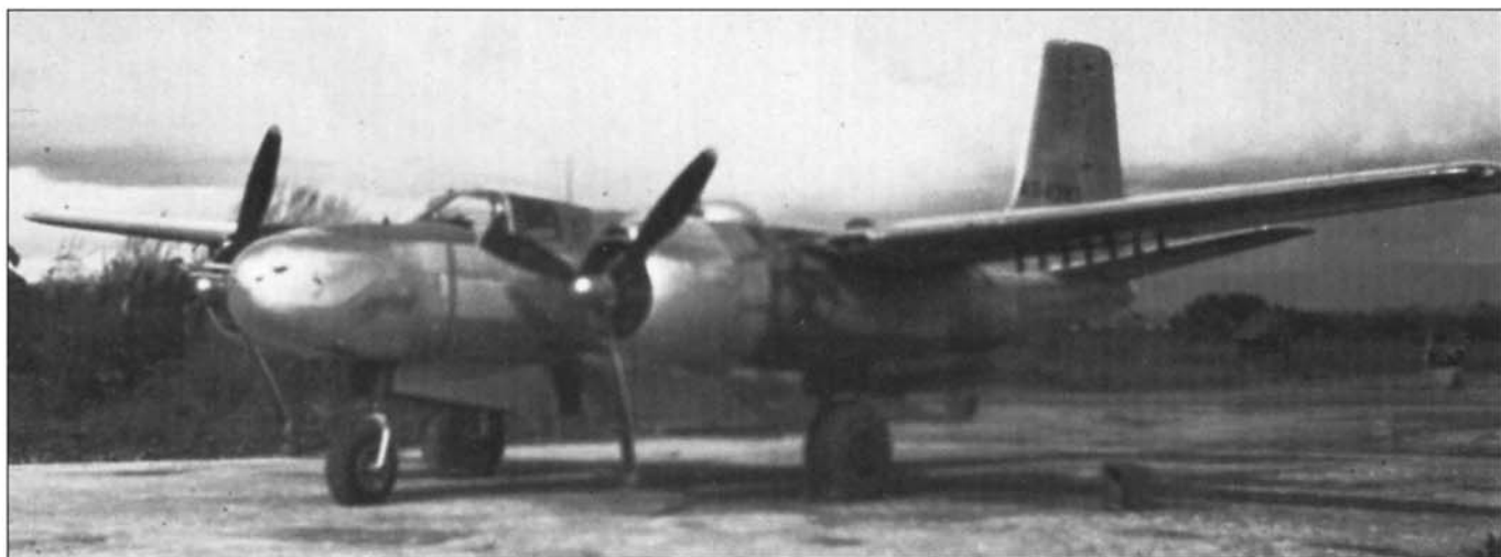
Неокрашенный, «металлический», А-26В с шестью пулеметами в носу. Вероятно, самолет принадлежит 319-й бомбардировочной группе, снимок сделан на Окинаве. Под крылом установлены узлы подвески для неуправляемых ракет HVAR.
