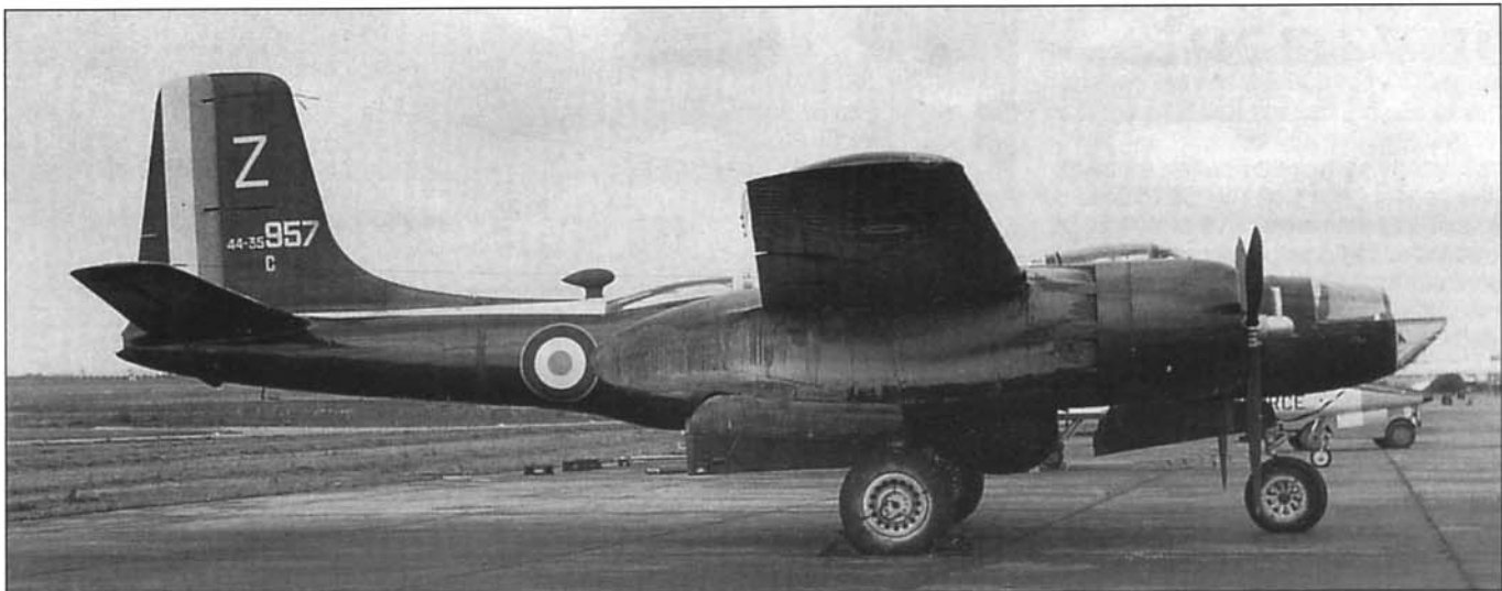
Большой обтекатель антенны на нижней поверхности фюзеляжа позволяет легко определить модификацию данного «Инвейдера» - В-26АРQ-13, предназначенный для тренировки операторов РЛС AN/APQ-13. В данной варианте модернизировали шесть самолетов.
