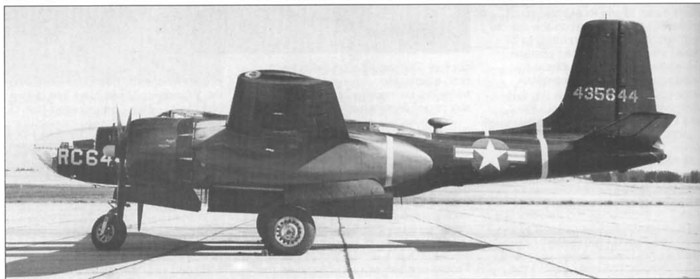
«RC» - по такой аббревиатуре легко отличить разведчик RB-26C от бомбардировщика B-26C. Внешние различия между этими модификациями невелики. Над фюзеляжем в каплеобразном обтекателе установлена антенна радиоконуса, радиоконусами комплектовались почти все разведчики RB-26C.
