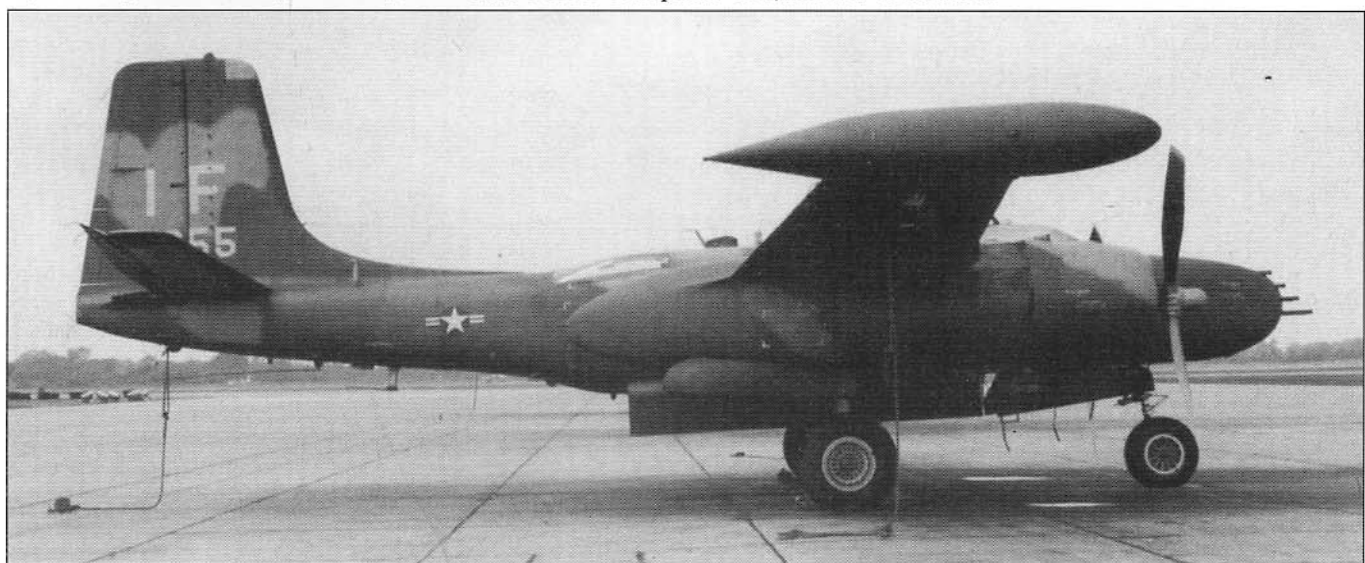
Обучение и подготовка экипажей самолетов В-26К велась на базе 603-й эскадрильи специального назначения. Самолеты 603-й эскадрильи несли на вертикальном оперении кодировку «1F», на бортах фюзеляжа были нанесены опознавательные знаки ВВС США – на самолетах, отправленных в Таиланд, опознавательные знаки на фюзеляжи не наносились. Самолет камуфлирован по трехцветной «вьетнамской» схеме, нижние поверхности окрашены в черный цвет, но у некоторых самолетов низ был окрашен в нейтрально-серый цвет.
