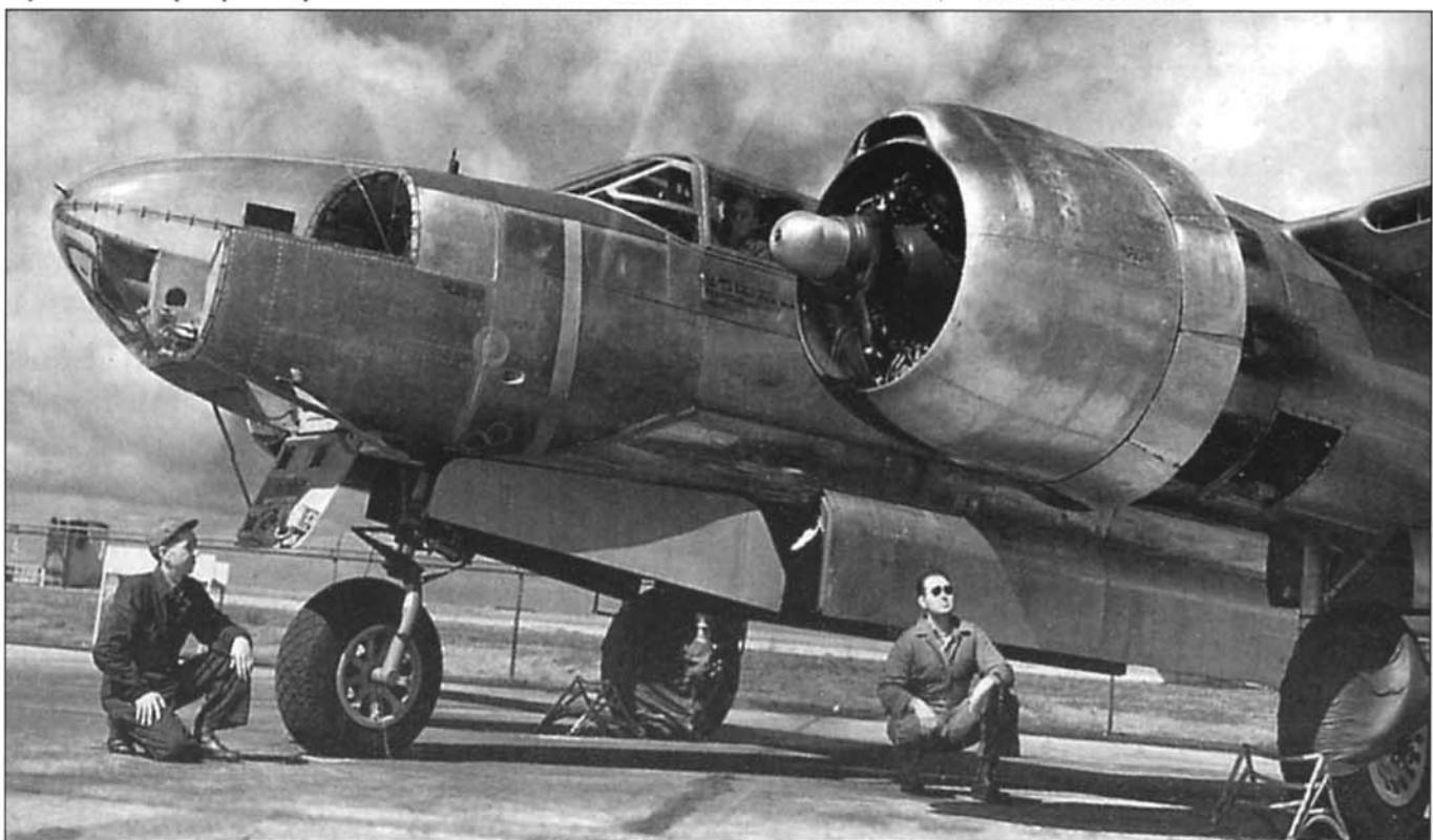
Техники следят за запуском двигателей на самолете А-26С-30-ДТ. На снимке хорошо видна плоская панель остекления в носовой части фюзеляжа и сбрасываемый в аварийной ситуации люк кабины штурмана.
