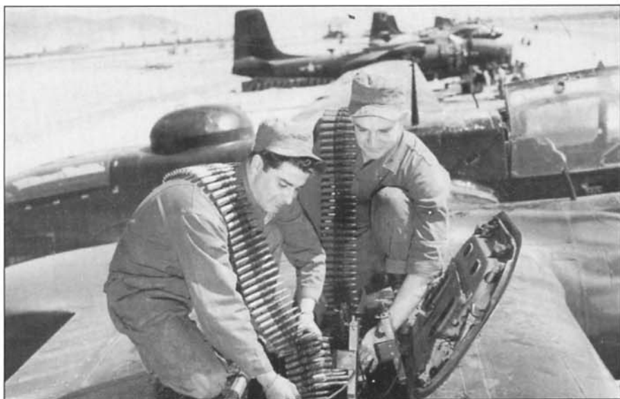
Вооруженцы снаряжают лентами крыльевые 12,7-мм пулеметы. Пулеметы в крыле «Инвейдера» были установлены почти так же, как в крыльях истребителей P-51 «Мустанг» и P-47 «Тандерболт».
