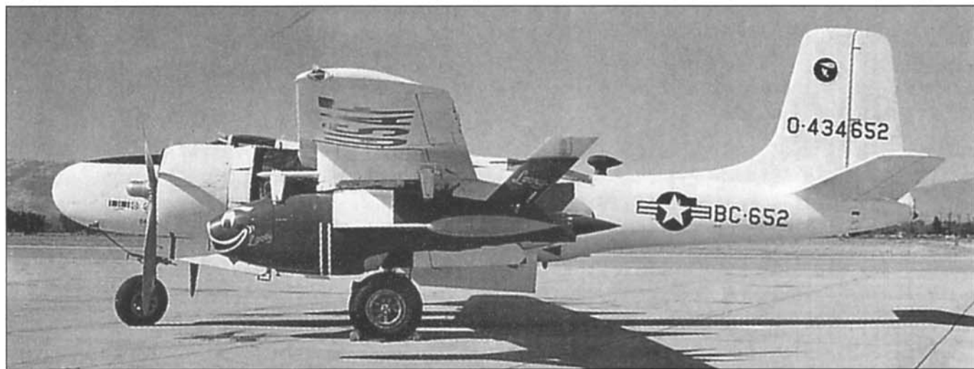
Единственный B-26B с БПЛА Райан Q-2A «Файрби». Этот образец БПЛА использовался для безмоторных испытательных полетов, по-планерному, в марте 1951 г. первый полет БПЛА с включенным двигателем состоялся летом 1952 г. Всего было изготовлено 1280 БПЛА данного типа, включая вариант KDA для ВМС США. В носители БПЛА «Файрби» было переоборудовано довольно значительное количество самолетов B-26C.
