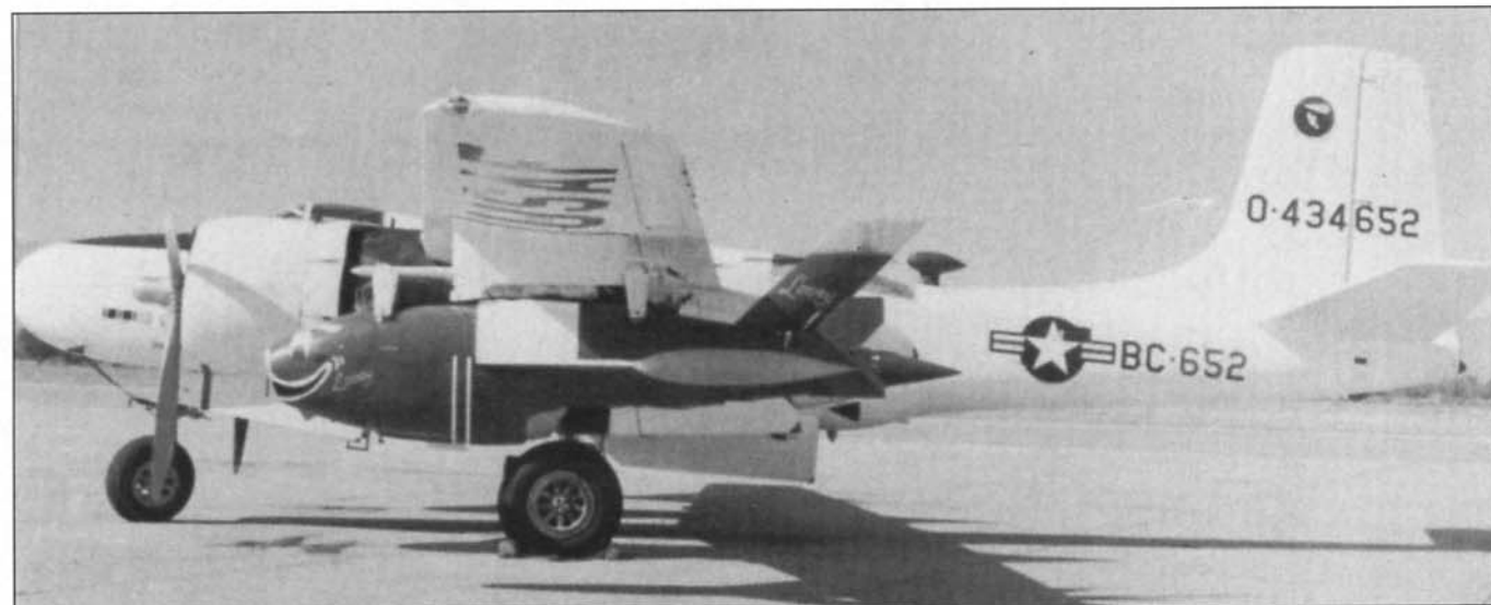
Самолеты-носители БПЛА обозначались DB-26D. На снимке – окрашенный полностью в белый цвет самолет DB-26D, капоты двигателей носителя окрашены в ярко-желтый цвет. Под крылом подвешен БПЛА «Файрби», аппарат окрашен в красный и белый цвета, законцовки крыла и оперения – желтые.
