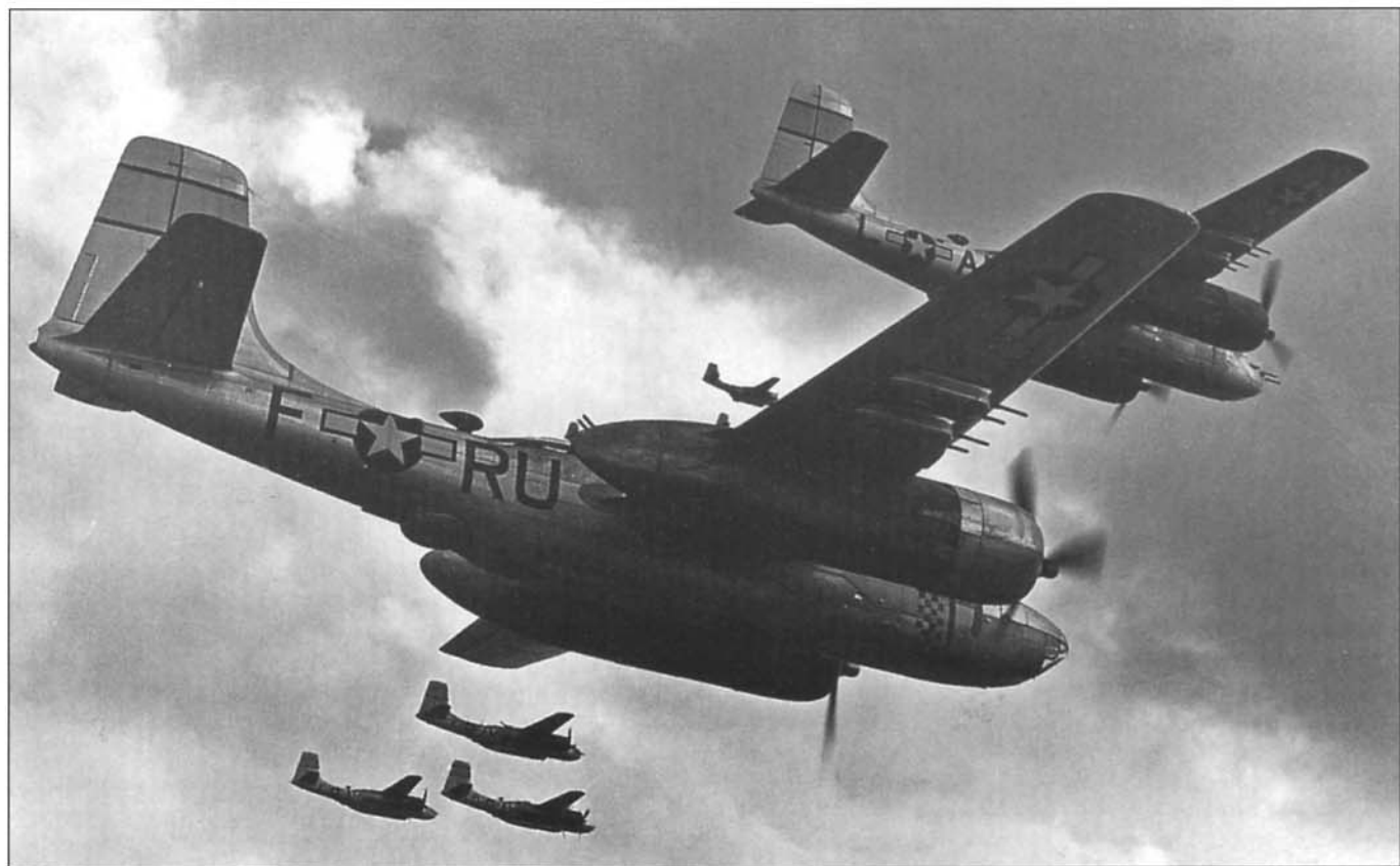
Самолеты А-26В и А-26С из 386-й бомбардировочной авиагруппы держат курс на Германию, апрель 1945 г. Под крыльями самолетов подвешены контейнеры с 12,7-мм пулеметами. Самолет обладал потрясающей мощностью бортового стрелкового оружия – помимо неподвижных крыльевых и носовых пулеметов вперед могли стрелять обе пулеметных турели.
