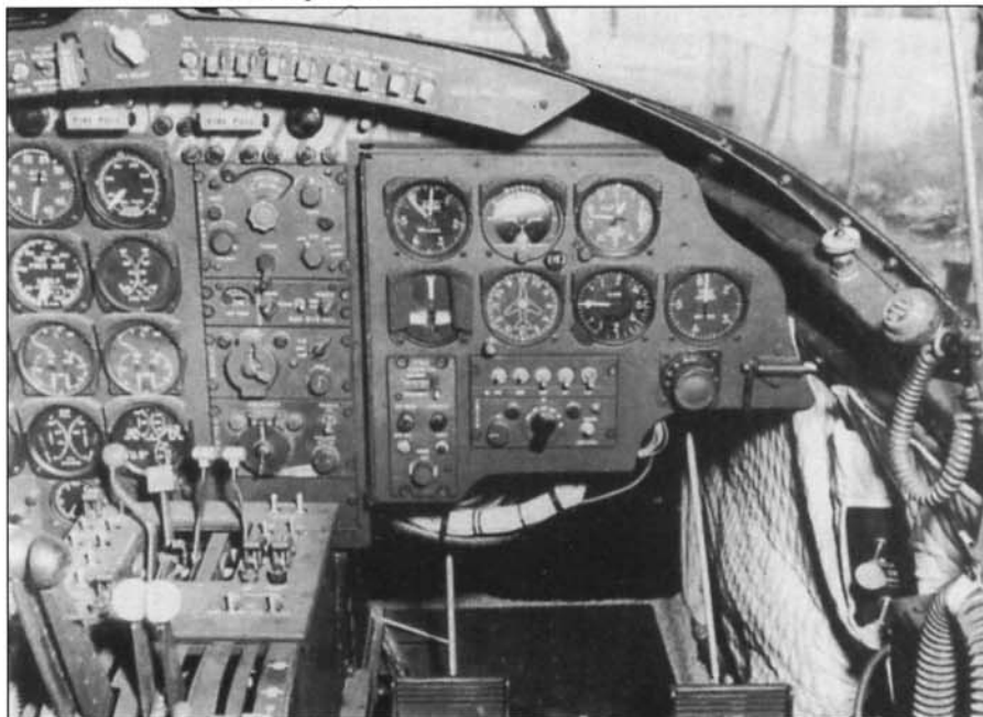
Самолет B-26К имел двойное управление, приборное оборудование кабины в значительной степени обновлено, установлен второй комплект пилотажно-навигационных приборов.
