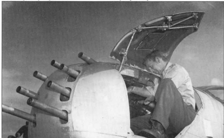
Восемь 12,7-мм пулеметов установлены в носовой оконечности фюзеляжа самолета А-26В вертикально в два ряда по четыре пулемета в каждом. Такое расположение пулеметов обеспечивало концентрированный обстрел цели. Именно такой вариант вооружения стал наиболее распространенным.
