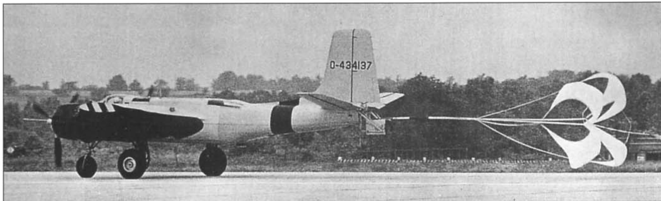
ЕВ-26В «Уинглесс Уондер» на испытаниях. «Бескрылое чудо» предназначалось для испытаний тормозных парашютов фирмы Пионер Парашют Компани.
