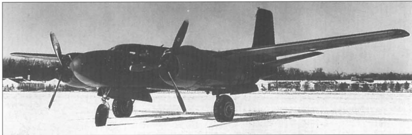
41-39100 – первый серийный А-26В. В отличие от прототипа крупноразмерные коки на воздушные винты серийного самолета не установлены. В остальном серийная машина внешне не отличается от прототипа.
