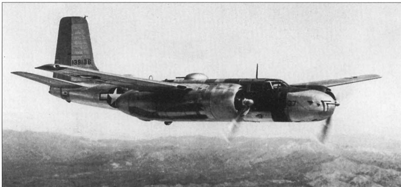
Восемь 12,7-мм пулеметов установлены в носовой оконечности фюзеляжа самолета А-26В вертикально в два ряда по четыре пулемета в каждом. Такое расположение пулеметов обеспечивало концентрированный обстрел цели. Именно такой вариант вооружения стал наиболее распространенным.
