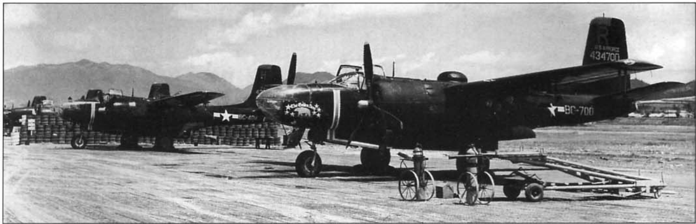
Линейка самолетов В-26С и В-26В из 17-го бомбардировочного авиакрыла на корейском аэродроме, 1953 г. Ближайший к камере самолет – В-26С, изначально построенный как А-26С. Вместо нижней пулеметной турели на самолете установлена аппаратура радионавигационной системы SHORAN.
