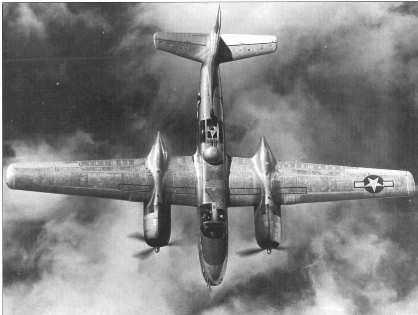
Хороший снимок А-26В с носовым вооружением раннего типа: четыре пулемета по правому борту и два по левому. Внутренние поверхности мотогондол окрашены в черный цвет, чтобы блики солнца не слепили пилота.
