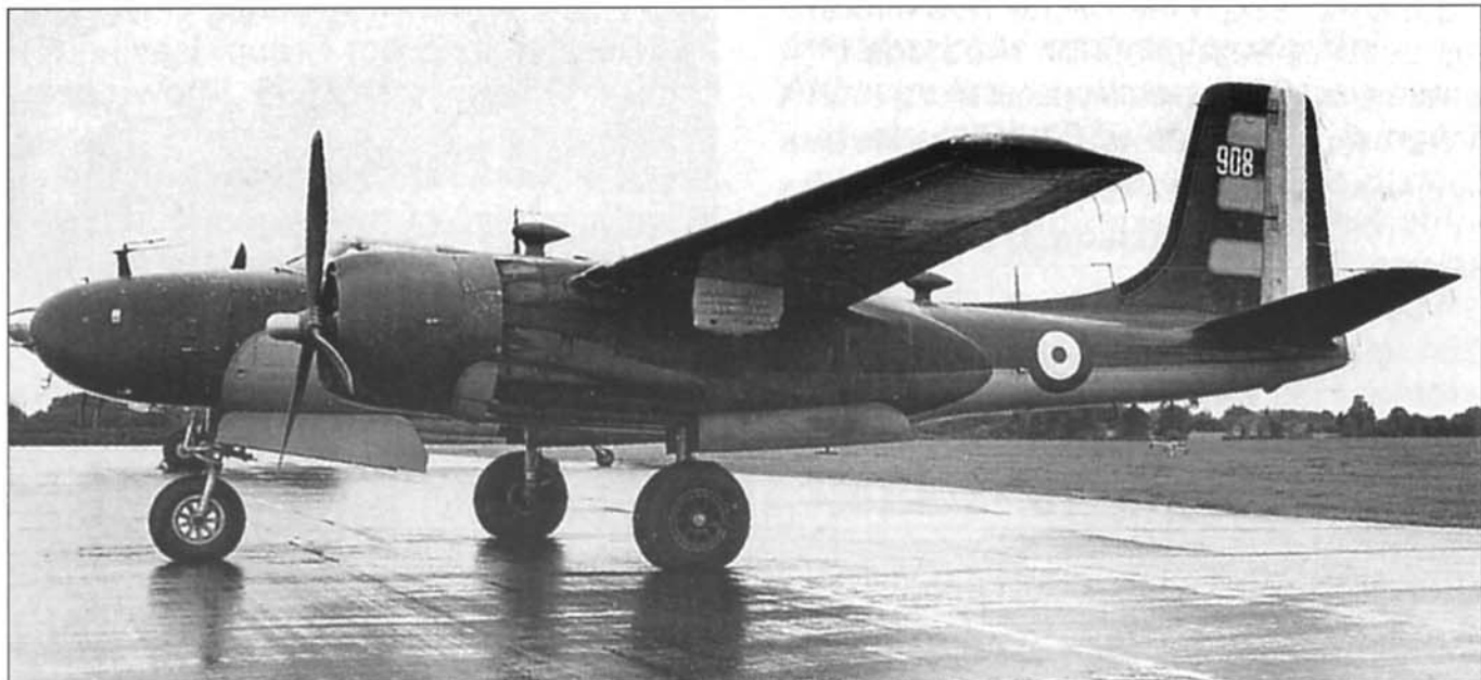
В-26В борт «908» французского исследовательского центра СЕУ. До покупки французами самолет прошел модернизацию в пассажирский самолет фирмой Гранд Сентрал.
