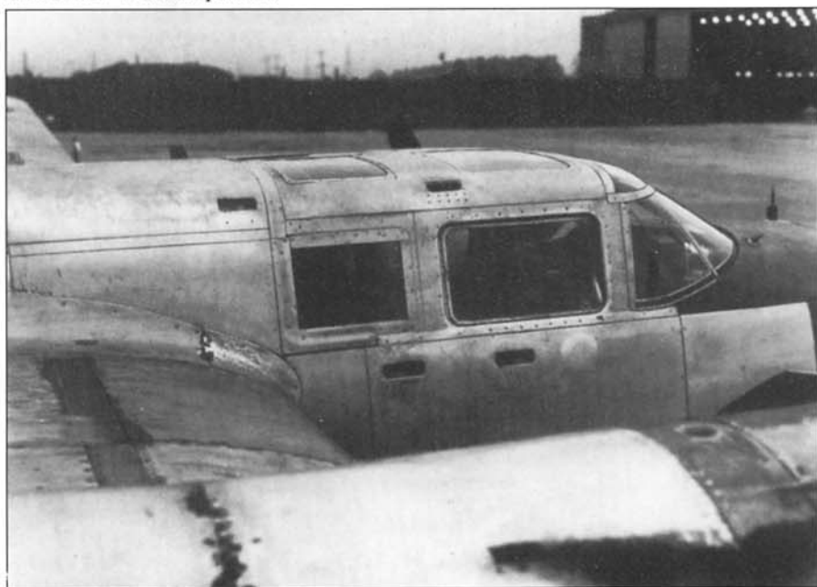
Крупный план фонаря кабины пилота у «Инвейдера» ранней постройки, крыша фонаря – плоская. Толстый переплет остекления кабины серьезно ограничивал обзор пилоту.
