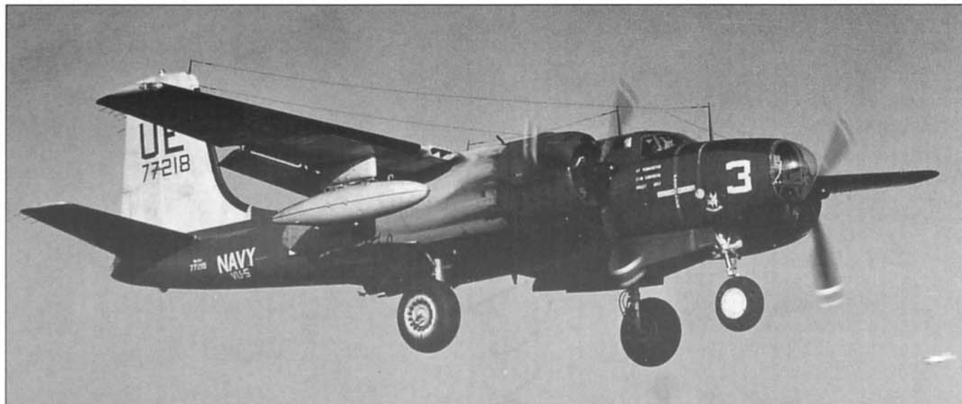
Морской «Инвейдер» с переделанной носовой частью фюзеляжа. Во флоте «Ивейдеры» использовались почти исключительно для буксировки мишеней. На снимке – самолет UB-26J из эскадрильи VU-5.
