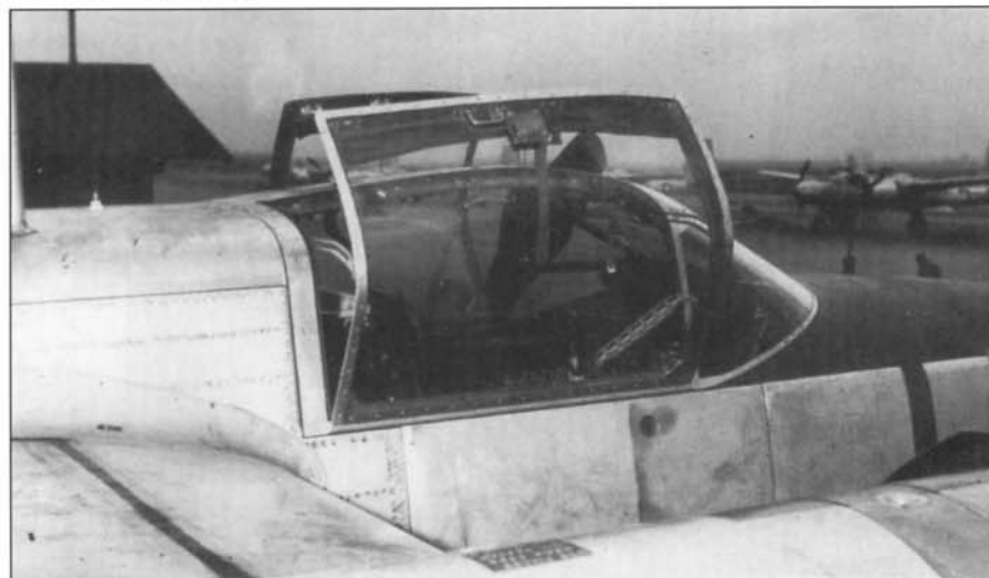
Для решения проблемы аварийного покидания кабины фирма Дуглас исследовала различные варианты остекления фонаря кабины. В конечном итоге был выбран почти беспереплетный фонарь с ярко выраженной каплеобразностью подвижных сегментов.
