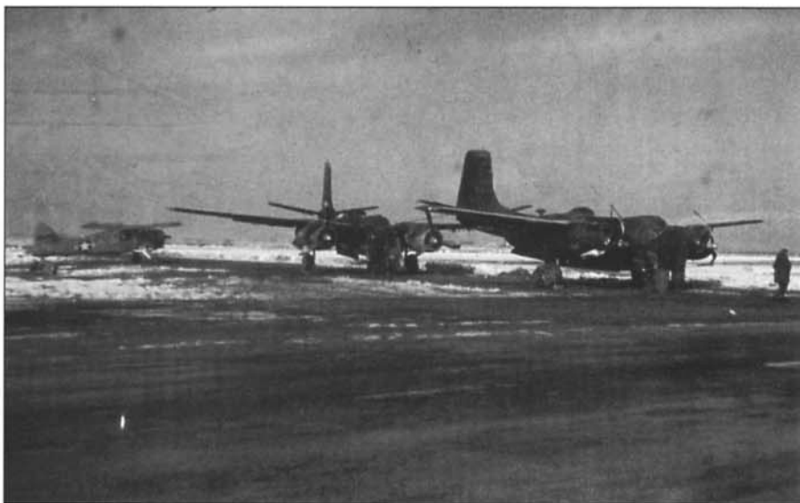
Самолетам В-26 и их экипажам досаждал не только огонь северокорейских зениток, но и обычная для Кореи арктическая стужа. В окружении глубочайших сугробов застыли два В-26. Двигатели укрыты теплыми чехлами, зачехлены кабины. Снег послужил причиной двух катастроф В-26, при этом у одного самолета отвалилась носовая часть фюзеляжа.
