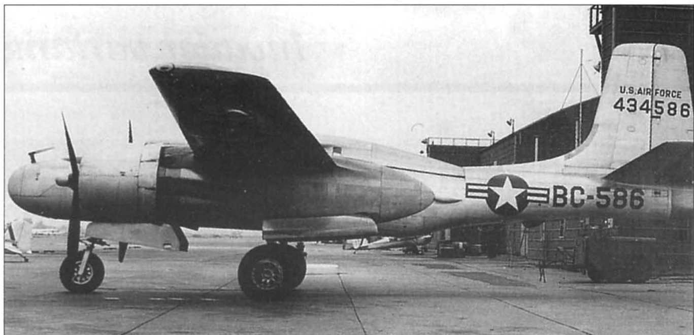
YB-26F в оригинальном виде, с трехлопастными воздушными винтами и без стрелкового вооружения. Трехдвигательный «Инвейдер» не получил дальнейшего развития, так как прирост скорости, который давал ТРД, был совсем незначительным.
